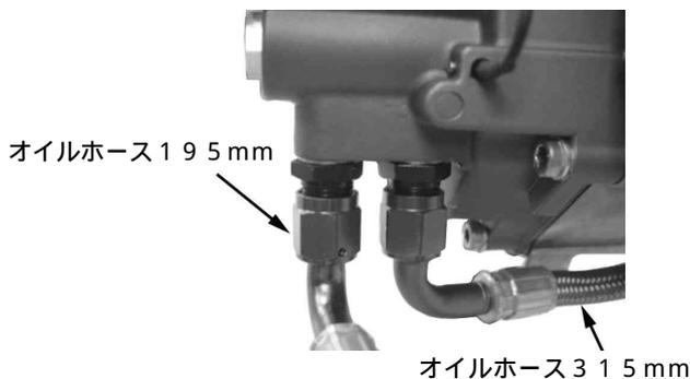
10. オイルホースが他の部分に著しく干渉しない様にオイルクーラーに取り付けます。オイルホースを乗車状態から見て右側のホースをオイルクーラー右側へ、左側のホースをオイルクーラー左側へそれぞれ取り付けます。取り回しが決まればオイルホースフィッティングを規定トルクで締め付けます。
