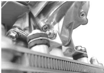
8. クラッチカバーのオイルプラグボルトを取り外し、アダプターM10にシーリングワッシャ10mmを通し、アダプターを取り付けます。
