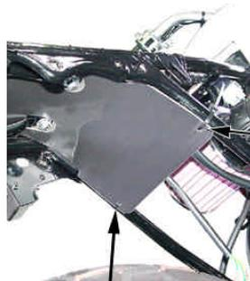
別売りリアマッドガード(09-09-16、17)を取り付ける場合は、リアマッドガードの下側2ヶ所をタイラップにて先にフレームに固定し、マッドガードを上から被せる様にリアマッドガードの上側の穴と、マッドガードの前方下側の穴をタイラップにて共締めして下さい。
