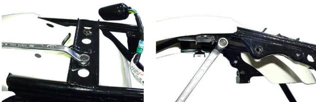
5. ノーマルテールランプに ボタンヘッドスクリューを通し、テールブラケットに フランジナットにて取り付けします。
