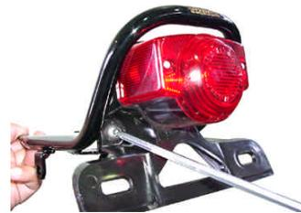
6. マッドガードに テールブラケットを通し、フランジボルト、フランジナットにて前方上面を仮止めします。マッドガードの向きに注意して下さい。(図 A 参照)
