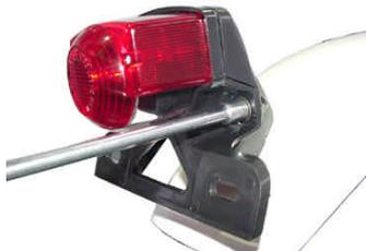
4. リヤフェンダーパイプを固定してある上部 2 箇所、左右各 1 箇所、のボルトを緩め、リアフェンダー及びリアフェンダーパイプを取り外します。
