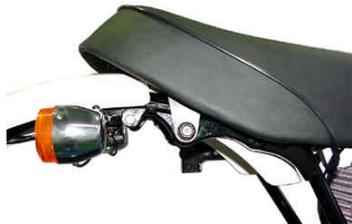
2. フェンダー裏のコード固定用タイラップをニッパー等で切断し、フェンダー穴よりコードを引き出します。
