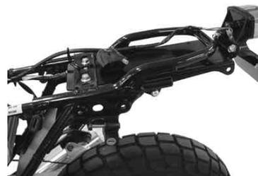
6. 別売りウインカーを フェンダーレスプレートに取り付け、ウインカーが地面に対して水平になるように固定し、ケーブルを裏面より表側へ穴を通して下さい。
