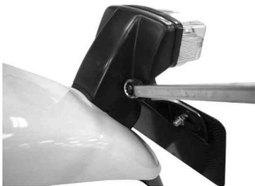
3. リヤフェンダーパイプを固定してあるボルトを緩め、リアフェンダー及びリアフェンダーパイプを取り外して下さい。
