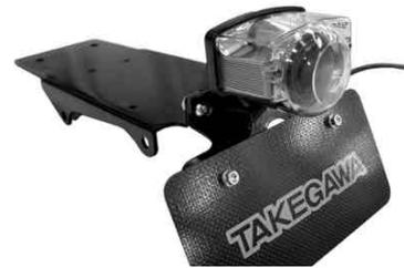
5. ボタネボルト、 フランジナットにて フェンダーレスプレートをフレームに固定して下さい。
