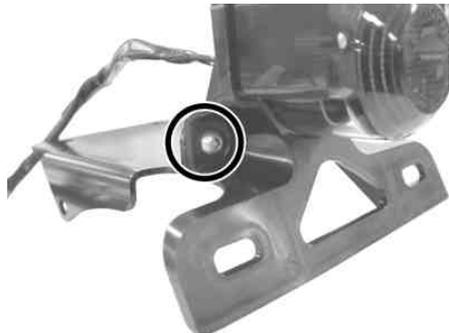
フランジボルト、フランジナットを使用し、フレーム リヤフェンダー フェンダーレスプレートの順になる様に取り付け、仮締めしておく。
