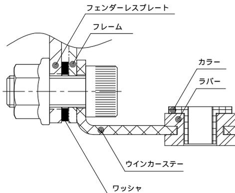
ウインカーライトをボルト アース端子 ワッシャ ウインカーライト シートラバー カラー キャップナットの順に取り付ける。
