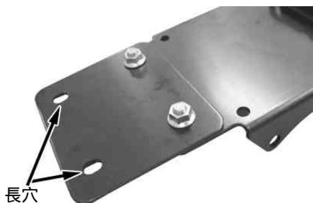
フレーム フェンダーレスサブプレートの順に フランジ六角ボルト、フランジロックナットで仮締めする。
