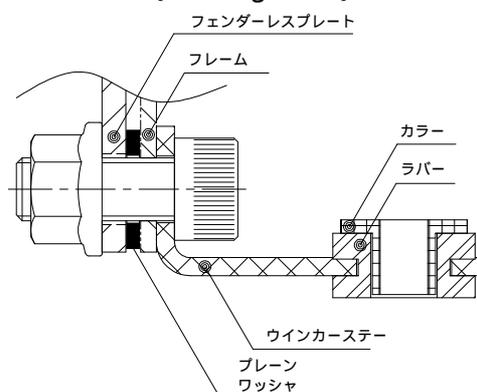
ウインカーライトをボルト アース端子 ワッシャー ウインカーライトシートラバー カラー キャップナットの順に取り付ける。
