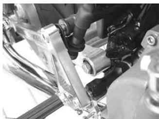
17. 両ホルダ - とホルダ - ステ - の位置決めをし、フランジボルト 6 × 15 2本とソケットキャップスクリュー 8 × 20 4本を本締めします。
