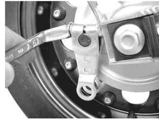
8. ブレーキロッドの加工: 当社製アルミスイングアームの16cmロング・TYPE-1(06-03-064および、06-03-065)を取り付けている場合はブレーキロッドが干渉します。
