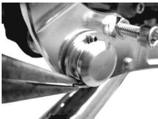
7. リアブレーキアームを下向きにシャフトに取り付け、フランジボルトとナットを締め付けます。
