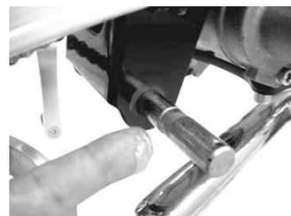
5. リアブレーキペダルのシャフトにブレーキペダルアームを差し込み、はみ出したグリスを拭き取ります。
