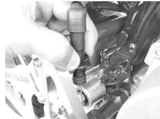
各部をもう一度規定トルクで増し締めし、確認を行って下さい。
