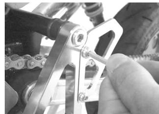
19. ロッドエンドL (逆ネジ) に (11) 6角ナット 6 mm L (逆ネジ) (13) をねじ込み、チェンジロッド (5) のマーク側に取り付け、ロッドエンド (10) と6角ナット 6 mm (12) も同様に取り付けます。いっぱいまでねじ込んで下さい。
