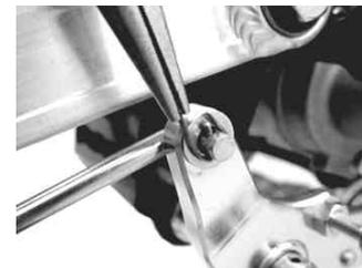
10. ブレーキロッドをブレーキスプリング、ブレーキアームジョイント、アジャストナットを用いてブレーキアームに取り付けます。
