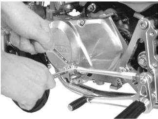
24. ブレーキペダルスプリング (27) をフレームのフックとブレーキペダルアームのスプリングフックの溝に取り付けます。
