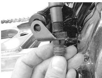
15. L ホルダ - をマウントナットとホルダ - ステ - 部にソケットキャップスクリュー 8 × 20 (31) 2本で仮締めします。
