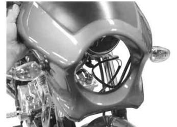
12. 取り付けが完了すれば、キット付属のフランジボタンヘッドスクリューでピキニカウルを固定します。
