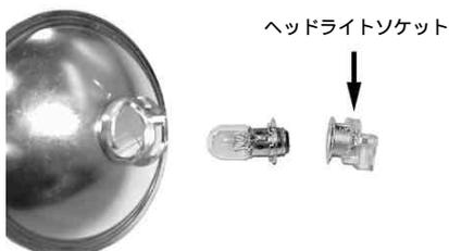
9. ヘッドライトケースのスクリュー取り付け穴がある方を下に向け、ヘッドライトステーに取り付けます。
