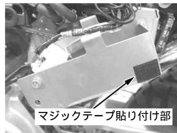
5. ノーマルサイドカバーを固定していたスクリューにプラスチックワッシャを取り付け、サイドカバーを締め付けます。
