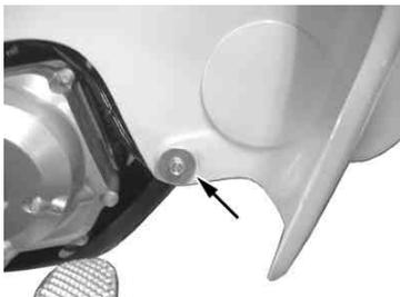
フロントカバーセッティングワッシャをキット付属のボルトで取り付け。
