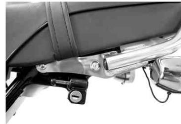
6. 項目(3)で仮止めした ボタンのボルト及び 六角ナットを締め付け固定して下さい。
