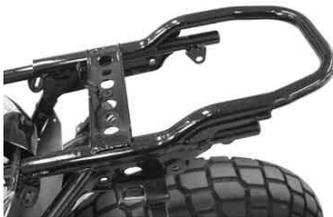
3. Grabber COMP の前方穴に ボタンのボルトを通し、フレームと Grabber COMP の間に カラーLを挟むようにして、フレーム裏側より 六角ナットにて仮止めして下さい。
