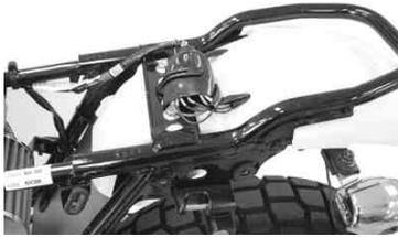
2. リヤフェンダーパイプを固定してあるボルトを緩め、リアフェンダー及びリヤフェンダーパイプを取り外して下さい。
