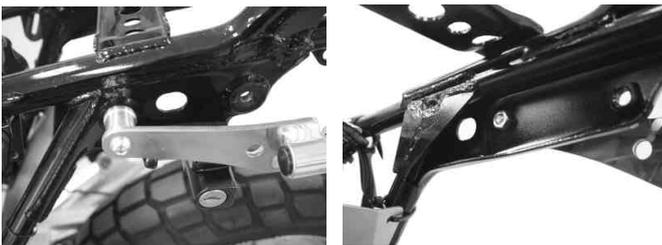
4. リヤフェンダー及びリヤフェンダーパイプを取り付け、テールランプ及びウインカーの配線を接続して下さい。
