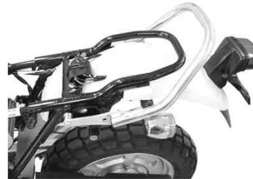
5. シートを取り付け、シートステーと Grabber COMP の間に カラーSを挟むようにして、ボタンのボルトにて固定して下さい。
