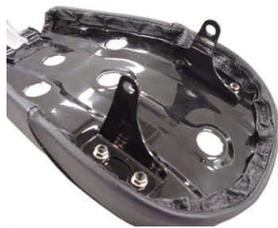
○シートブラケットの長穴でシートの位置を調整し、フランジナットを規定トルクで締め付けます。
